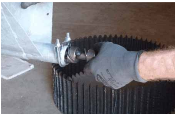
Рис. 11-19: Крепко держите вал натяжения
