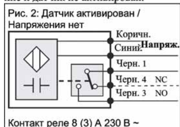
Рис. 13-2: Описание датчика MS45R
