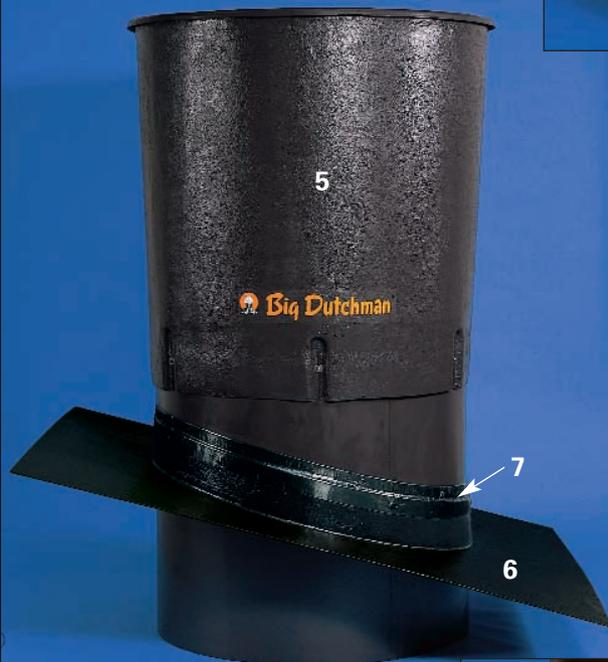
Для каминов малых диаметров (35-71 см) используется сервомотор Belimo. За счет применения диффузора (5) увеличивается количество вытяжного воздуха (эффект Вентури). Также сводится к минимуму количество влаги, попадающее в камин во время дождя. Стандартный камин поставляется с гибкой кровельной пластиной (6) и уплотнен просмоленной лентой (7). Жесткая кровельная пластина из стеклопластика поставляется по запросу в соответствии с имеющейся поверхностью кровли.
