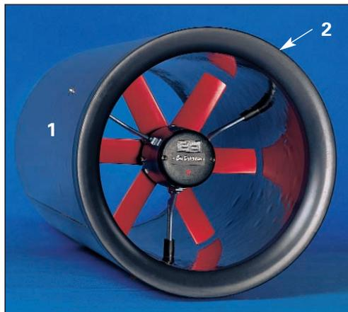
Вытяжные камины «Биг Дачмен» состоят из полиуретановой трубы толщиной 50 мм (1), не содержащей углеводород фтористого хлора, покрытой слоем гладкой армированной стекловолокном пластмассы. Направляющая насадка (2) из полиэтилена закрепляется с обеих сторон камина (вверху и внизу) = повышенные аэродинамические качества. Для закрытия камина используется стандартный поворотный клапан (3) с сервомотором CL 74 (4).
