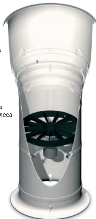
Изображение воздушной струи на выходе из камина, с колесом спрямления и без него
