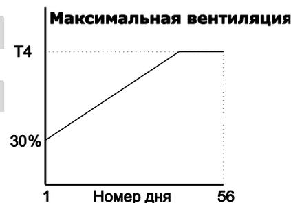
Точки перегиба кривых минимальной и максимальной вентиляции можно ввести на экране, указанном ниже.
