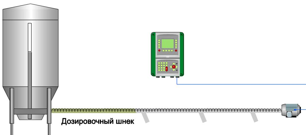
3. Накопители заполняются последовательно по принципу переполнения. Когда последний накопитель заполнен (определяется с помощью датчика потребности), раздаточный компьютер прекращает подачу корма.
