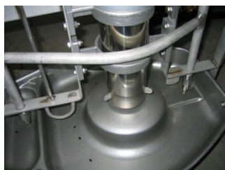
кормушка для PigsFeeder single (размеры (ШхДхВ): 616 x 485 x 87 мм)
