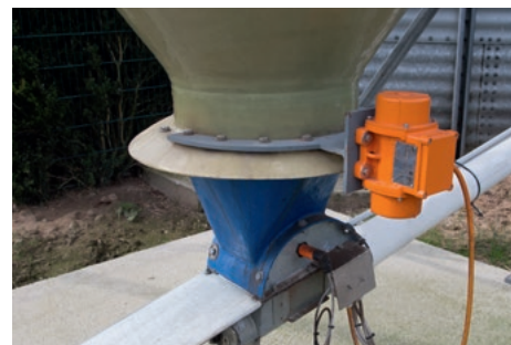
Бункер с электрическим вибратором
