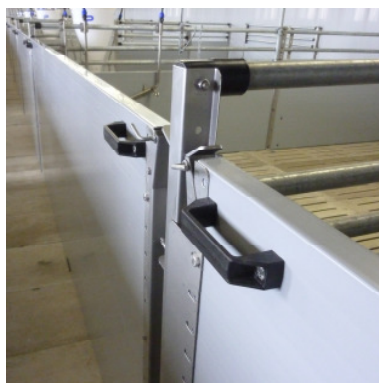
Механизм для открытия одной рукой
